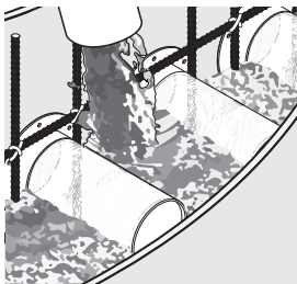
将混凝土浇入 导模中
